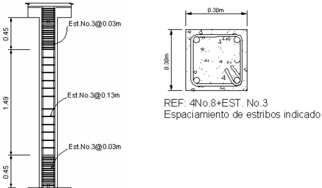
Figura 33. Armado final de columna
