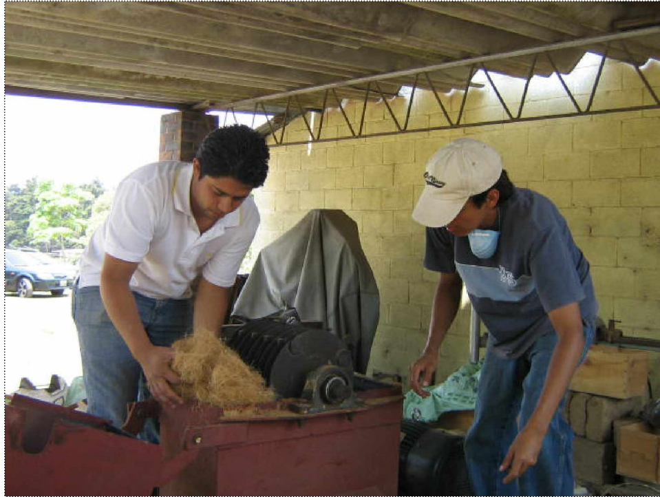
Figura 18. Extracción de fibra por medio de una máquina especial
