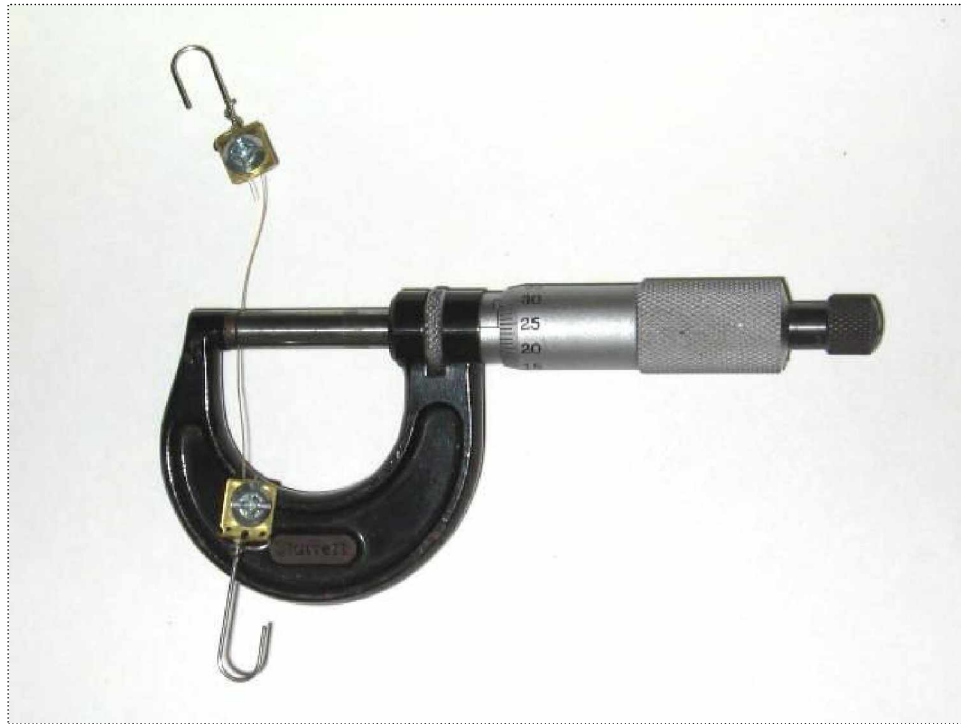
Figura 21. Micrómetro utilizado para lectura de diámetros de las fibras
