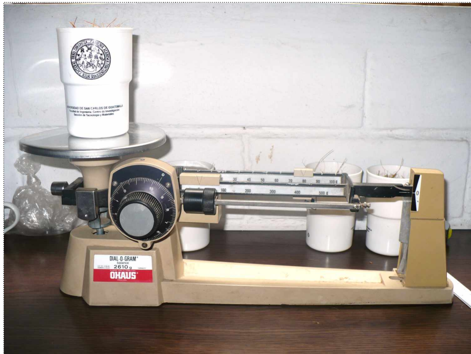
Figura 30. Pesado de tara y fibras en ensayo de absorción
