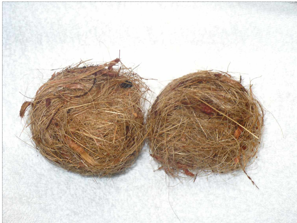
Figura 29. Manojos de fibras de coco sometidas a ensayo de absorción
