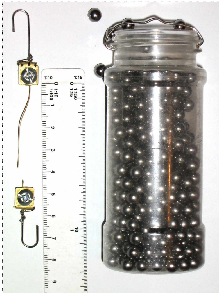
Figura 33. Mordazas y pesos utilizados en ensayos de fibras de coco
