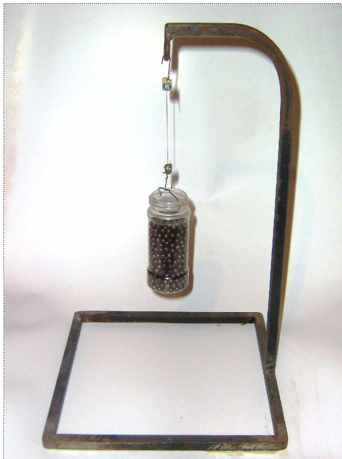
Figura 32. Base metálica para ensayos de fibras de coco
