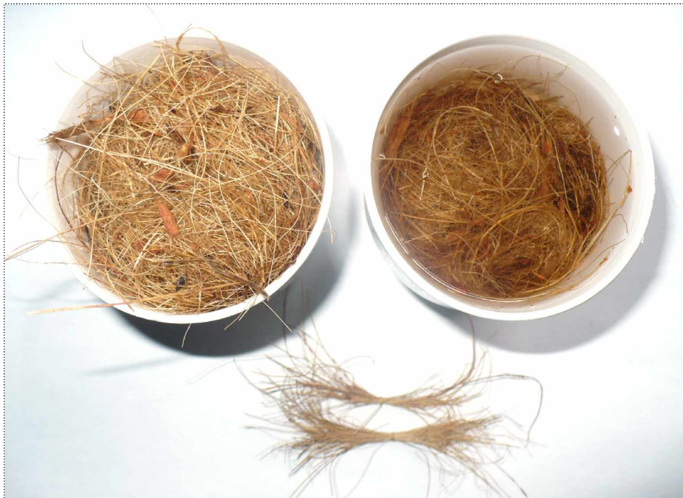
Figura 31. Muestra secosaturada y muestra sumergida en agua
