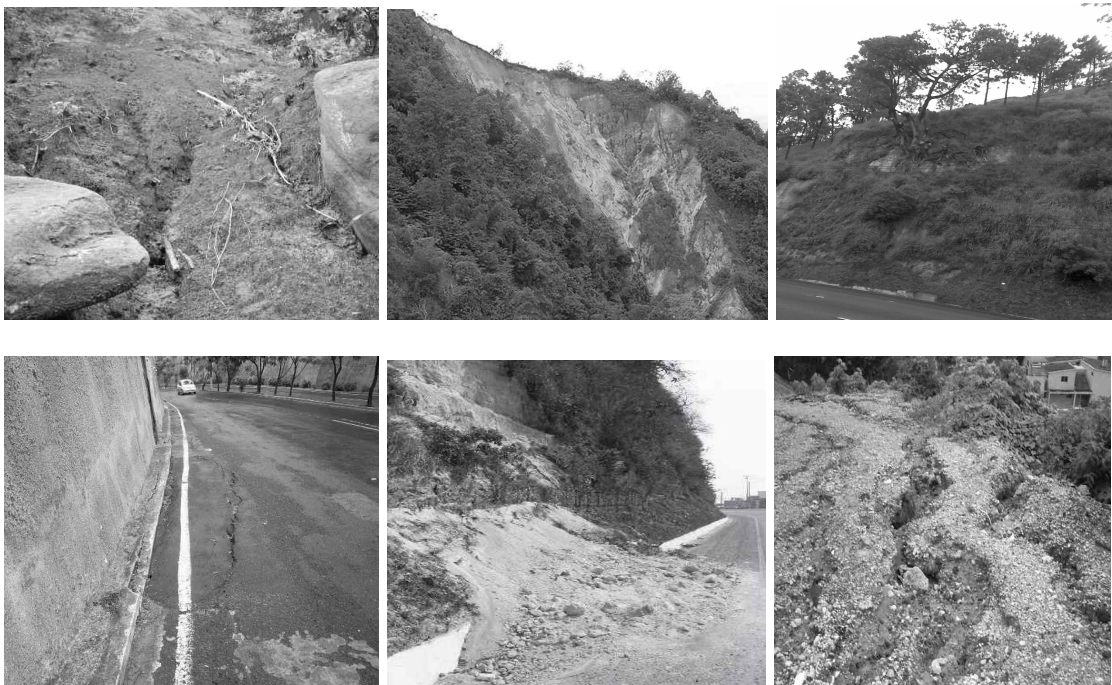
Figura 24. Características para identificar un deslizamiento en curso o potencial.
