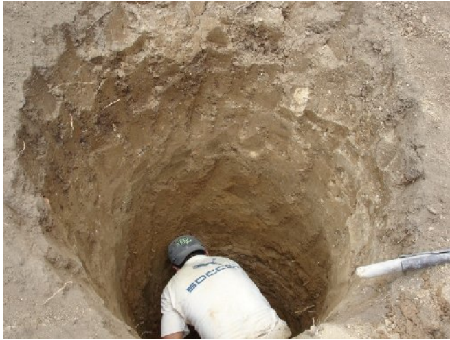
Figura 4. Obtención de muestras inalteradas
