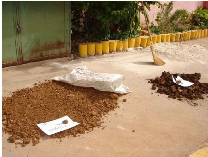
Figura 5. Muestras alteradas puestas al sol para secar
