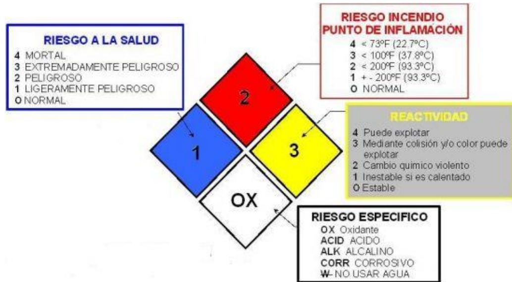
Figura 22. Sistema de identificación de riesgos químicos
