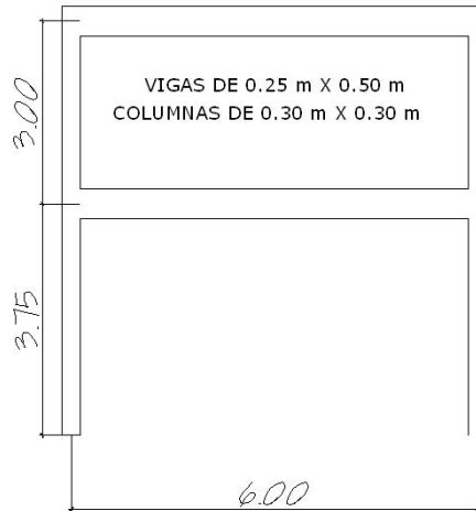
Figura 33. Configuración de marcos en sentido Y
