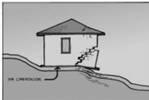
Figura 89. Vulnerabilidad alta en vigas de cimentación
