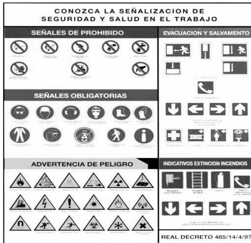
Figura 15. Señales de seguridad y salud en el trabajo
