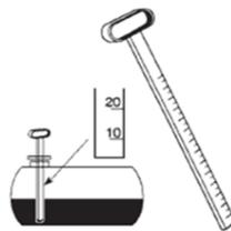
Este método es efectivo y ampliamente utilizado para medir el nivel en los tanques de una gasolinera, pero no es muy práctico si el contenido a medir es tóxico o corrosivo, ya que el individuo que introduce la varilla debe estar de pie sobre la abertura del tanque para manejarla. La determinación del nivel se efectúa al introducir la varilla en el tanque observando a que longitud de la varilla se encuentra mojada por el líquido.
