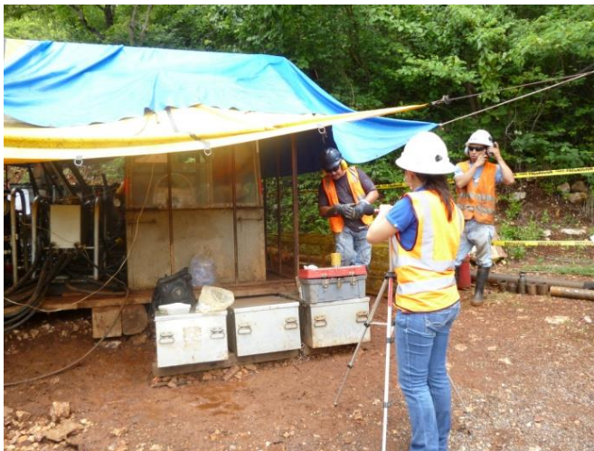
Figura 35. Medición de ruido en área de motores y servicios
