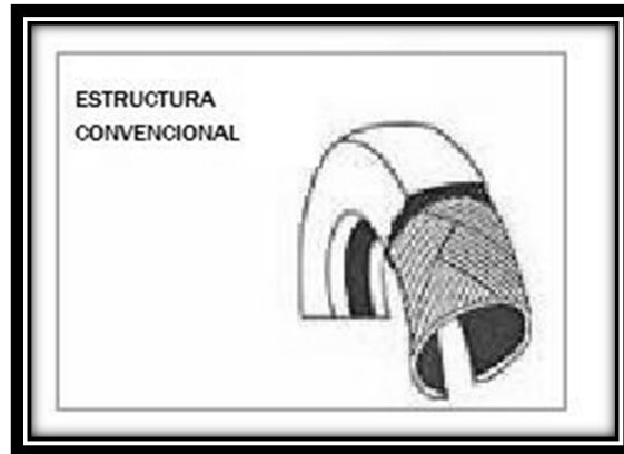
Figura 2. Estructura de llanta convencional
