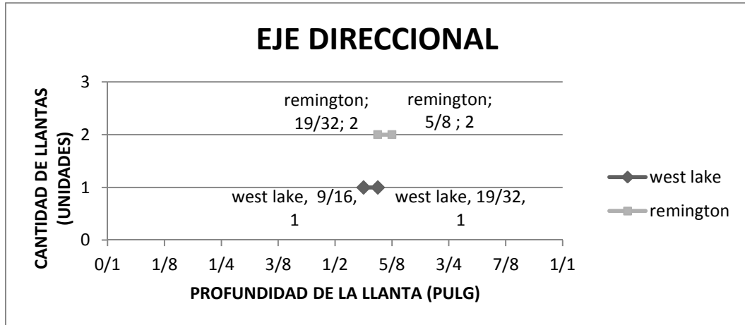
Figura 38. Variación de la profundidad eje direccional por marca a los 20 000 kilómetros
