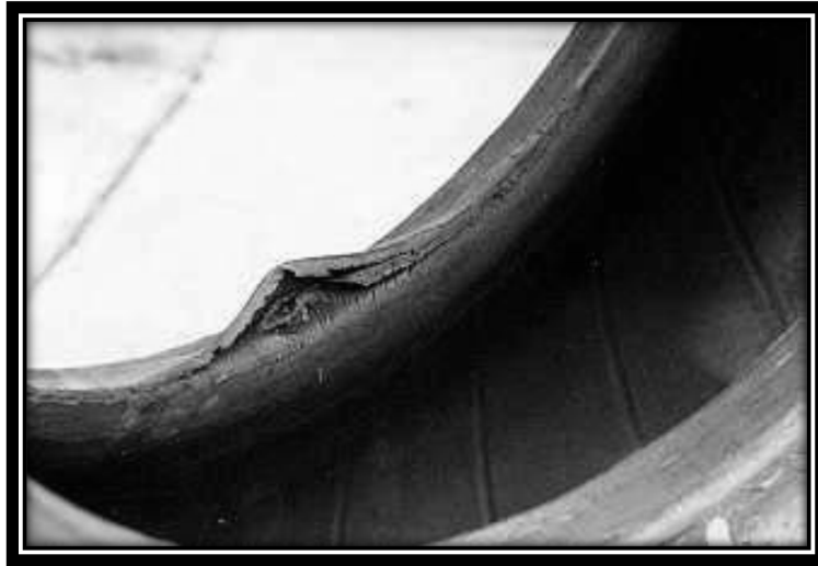
Figura 23. Daños por el aro
