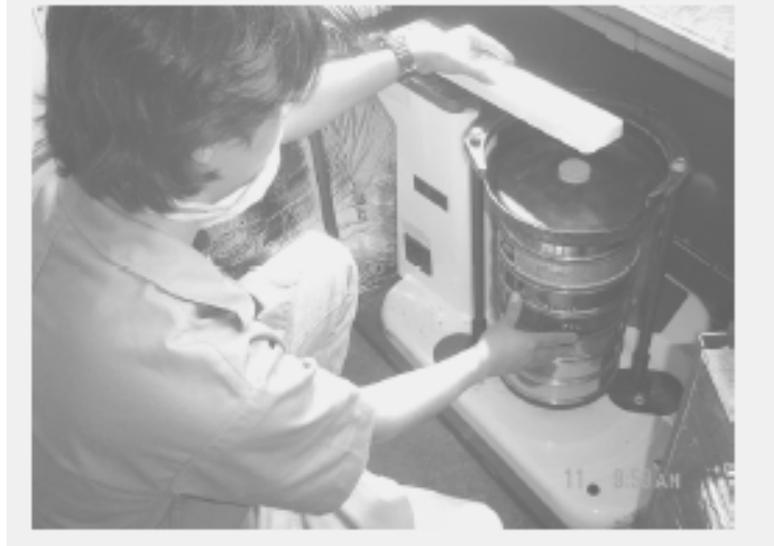
Figura 10. Tamizadora para agregado grueso con tamices de 2", 1 ½", 1", ¾", 1/2", 3/8", y No.4 y fondo.
