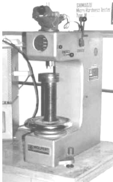
Figura 15. Durómetro.
