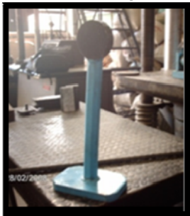
Figura 14. Mandril utilizado para doblado de barras
