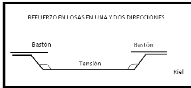
Figura 30. Elementos del refuerzo en losa
