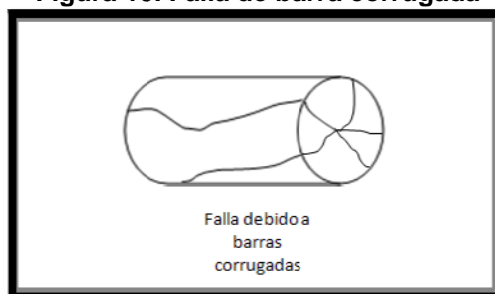
Figura 10. Falla de barra corrugada
