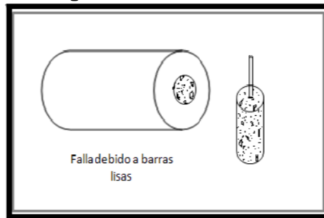
Figura 9. Falla de barra lisa
