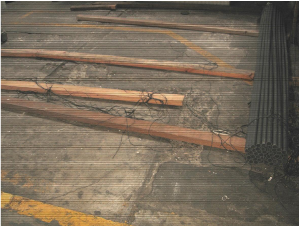
Figura 11. Piezas para primera cama de tubos sobre el piso
