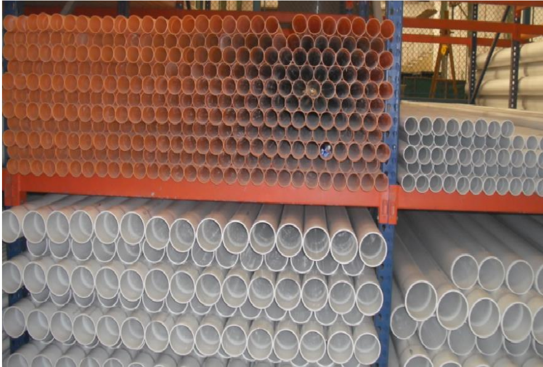
Figura 33. Apilamiento de tuberías en racks
