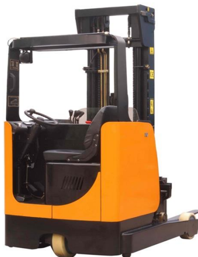
Figura 19. Montacargas eléctrico reachtruck
