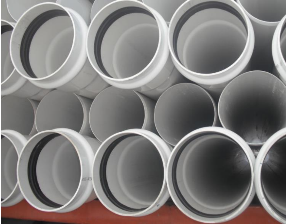
Figura 34. Apilamiento de tuberías con espiga
