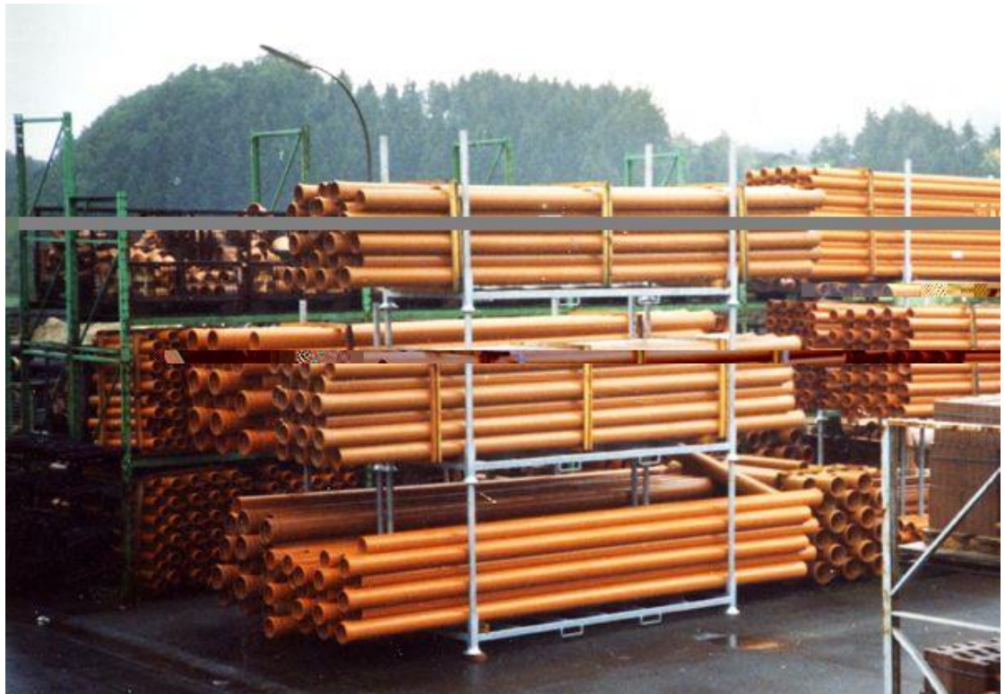
Figura 14. Estibas de 3 y 4 niveles
