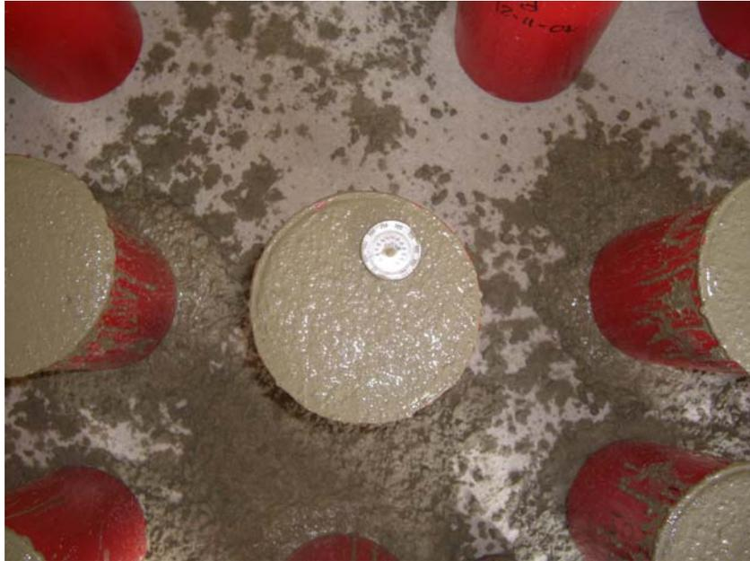
**Figura 3 Toma de muestras concreto fresco**
