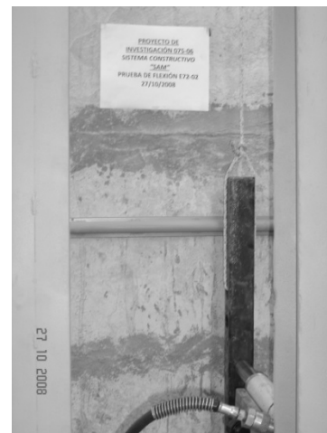
Figura 96. Identificación de ensayo a flexión sistema constructivo SAM
