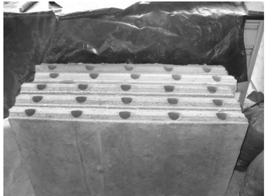
Figura 48. Almacenamiento de bloques fibrorreforzados
