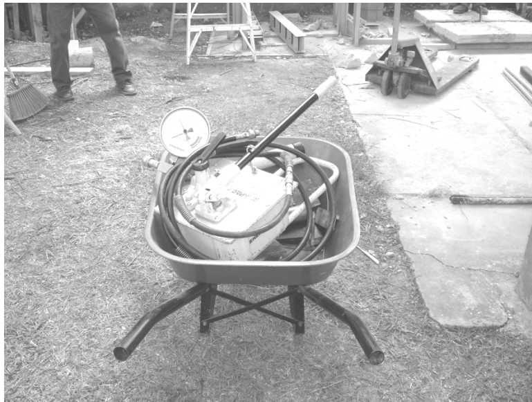
Figura 133. Boba hidráulica ENERPAC P- 462 con accesorios y manguera hidráulicas
