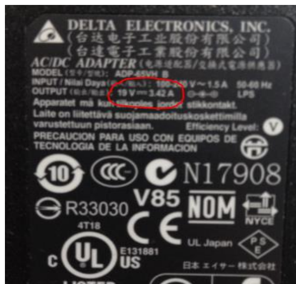
Figura 40. Ejemplo de los datos observados de los aparatos eléctricos
