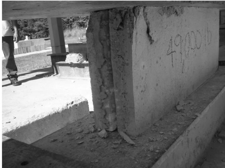
Figura 22. Falla de la muestra 5 en ensayo a compresión.
