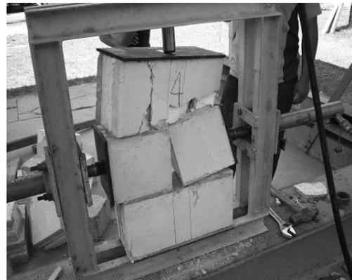
Muestra 3 para ensayo de adherencia. Falla en prisma 4, ensayo de adherencia.
