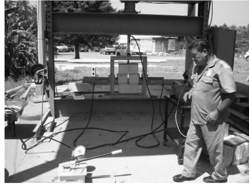
Prismas para ensayo de adherencia. Muestra 1 para ensayo de adherencia.
