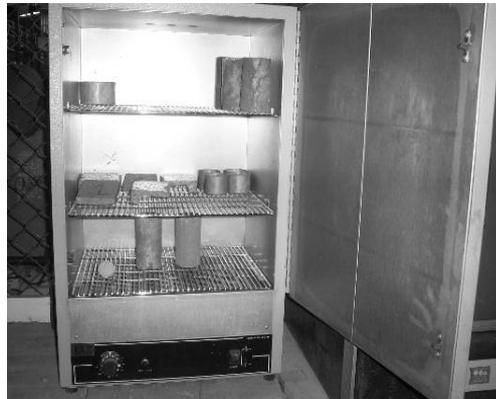
Horno para ensayo de absorción.
