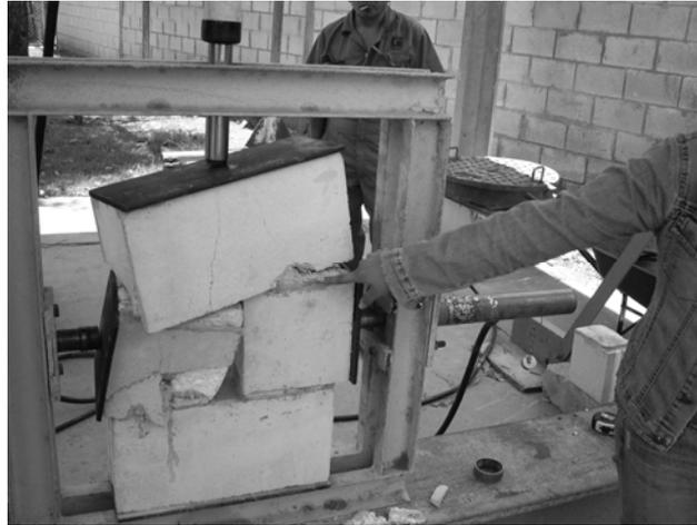
**Figura 30. Falla de la muestra 3 en ensayo de adherencia.**
