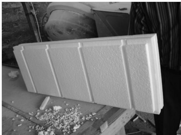
**Figura 2. Vista frontal de la membrana de poliestireno expandido.**
