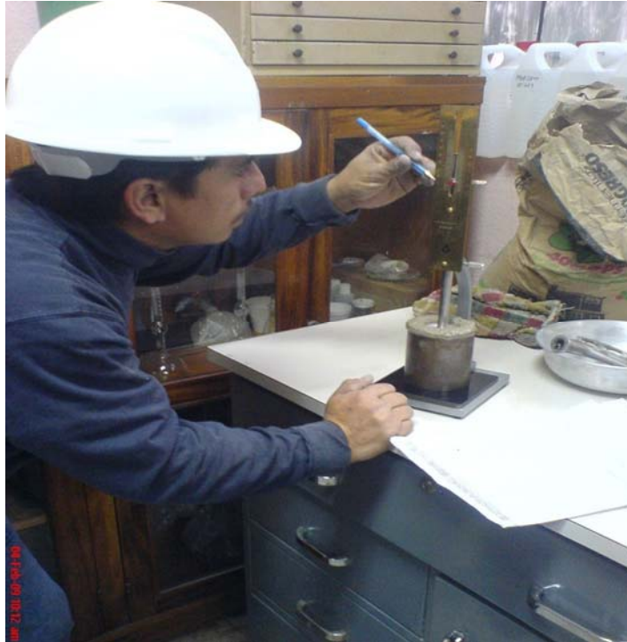
Figura 14 Evaluación de morteros estado fresco
