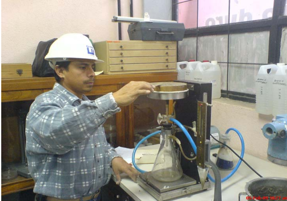
Figura 15 Evaluación de morteros estado fresco
