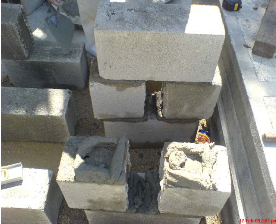
Figura 21 Ensayo de adherencia
