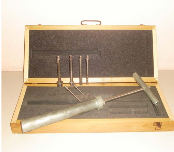
Figura 7 Equipo ensayo velocidad de endurecimiento, resistencia a la penetración
