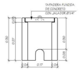
CAJA LLAVE DE PASO SECCIÓN esc: 1: 7.5
