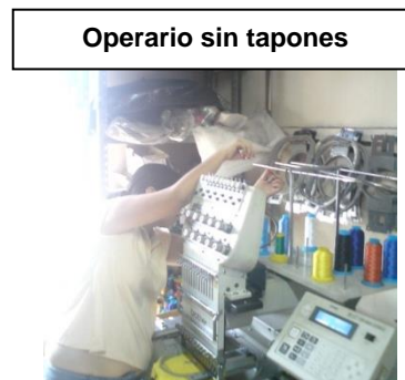
Figura 20. Operario de bordadoras sin tapones para oídos
