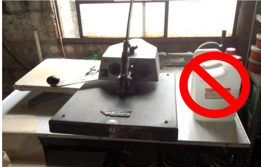
Figura 23. Mal posicionamiento de líquidos inflamables
