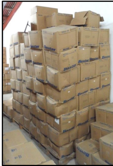
Figura 9. Tarima de cajas con exceso de estiba
