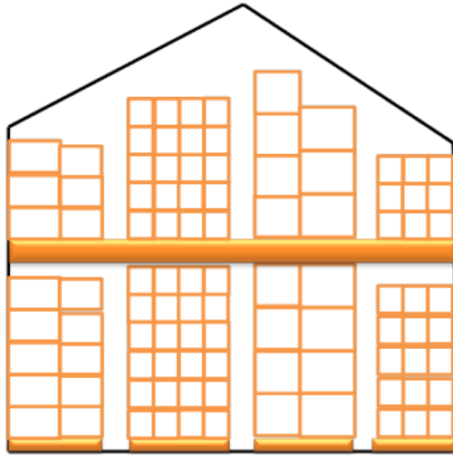
Figura 31. Vista lateral de la bodega utilizando el Sistema Mezzanine
