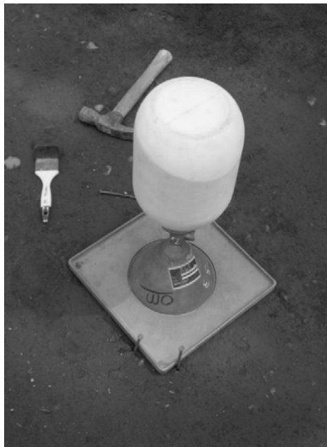
Figura 13. Colocación del picnómetro sobre la placa base
