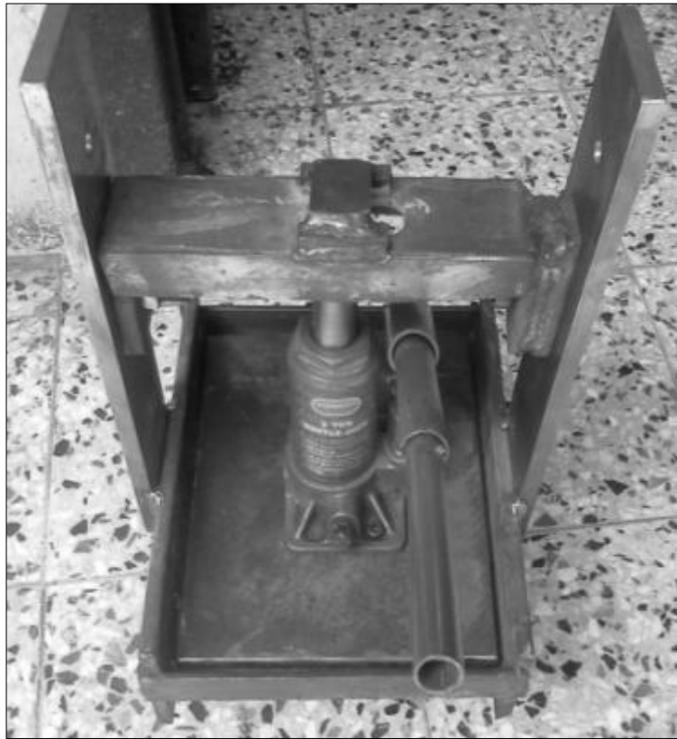
Figura 37. Prototipo con sistema de calentamiento eléctrico y capacidad de compresión de 2 toneladas
