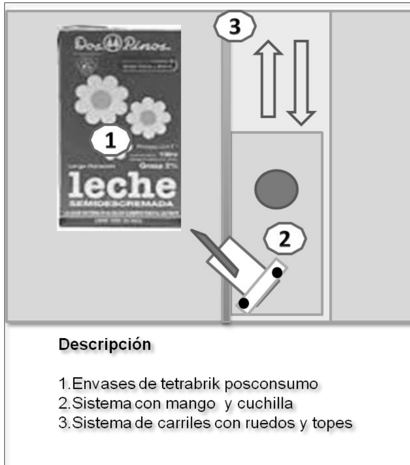
Figura 28. Bosquejo del funcionamiento del prototipo de corte
