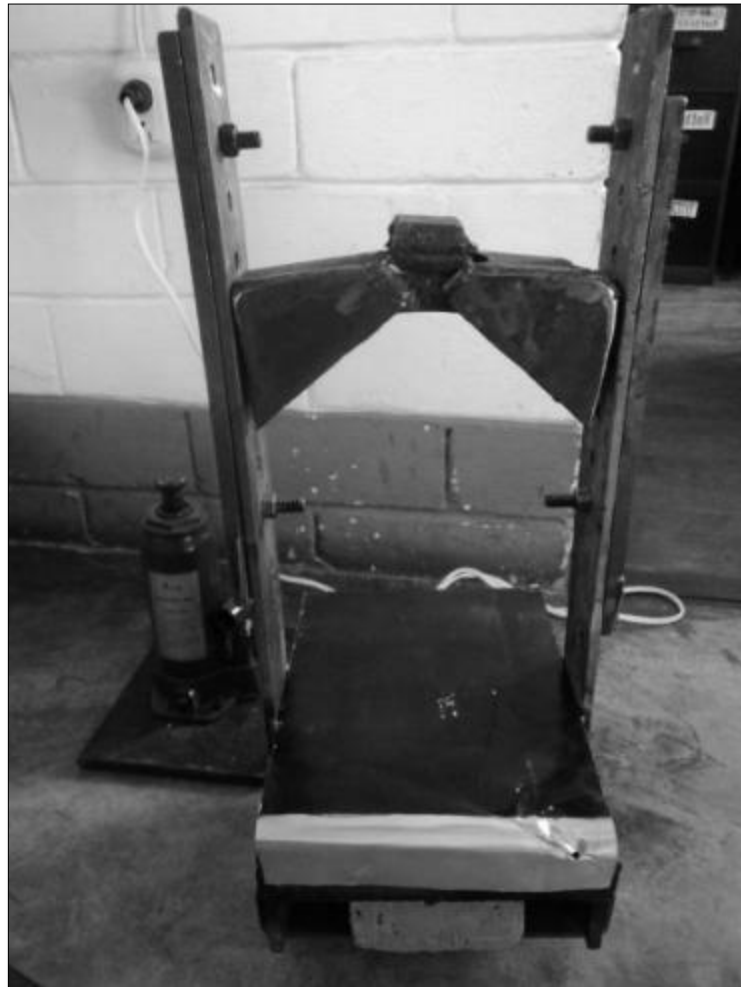
Figura 44. Prototipo con sistema de calentamiento eléctrico y capacidad de compresión de 6 toneladas
