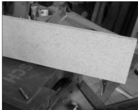
Figura 57. Aplicación de fórmica en las planchas de tetrabrik
