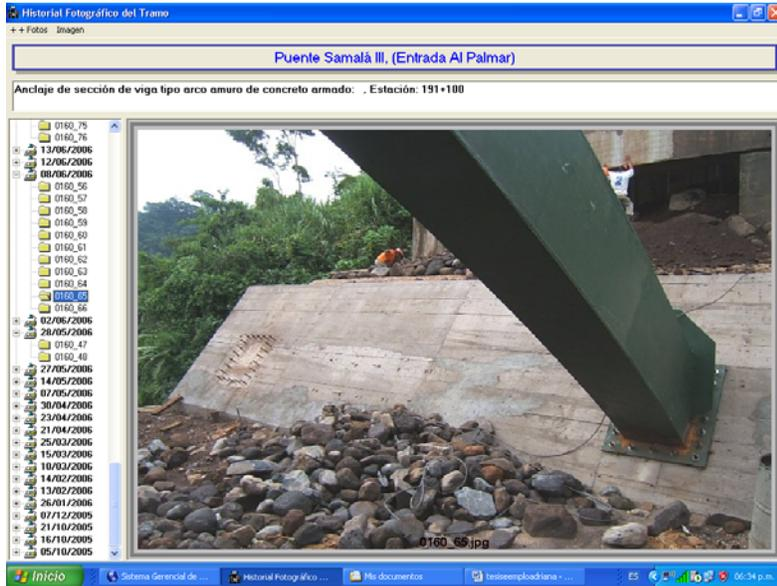
Figura 23. Última fase de instalación central de la viga principal en forma de arco del lado derecho; y la viga de lado izquierdo esta completa.
