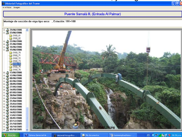
Figura 24. Instalación de columnas verticales y vigas transversales conectoras, para la nivelación horizontal del puente.
