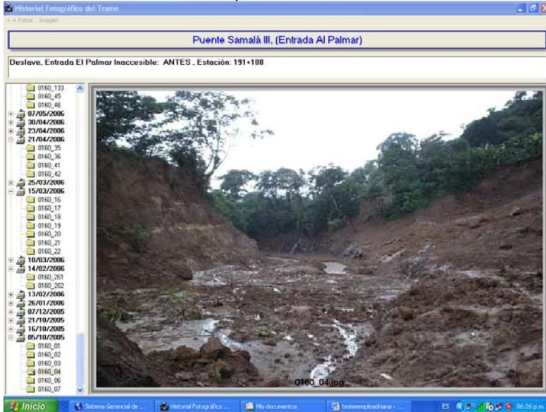
Figura 19. El deslizamiento de tierra llegó al área que ocupaba el puente antiguo y visualizar el corte e interrupción total del paso vehicular. Puente Colapsado en su totalidad.
