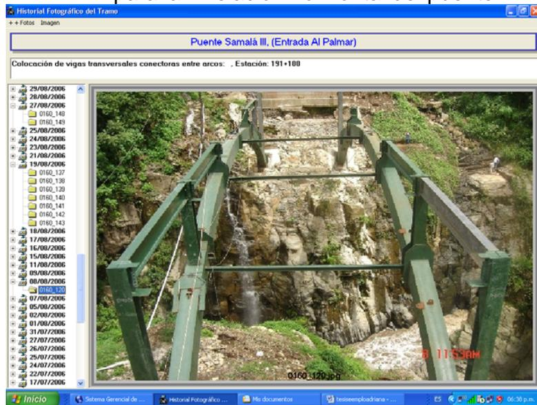
Figura 25. Colocación de andamio en la primera parte del tramo del puente, para la instalación de la losa acero.
