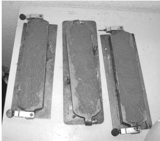
Figura 24. Fotografía de briquetas de mortero de escoria de ferroníquel
