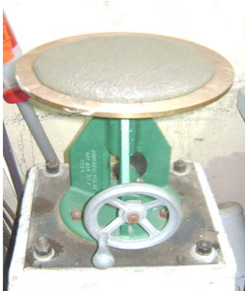
Figura 18. Fotografía del ensayo flow o manejabilidad del mortero
