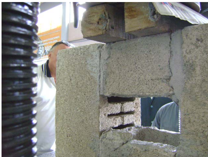
Figura 28. Fotografía de un prisma en el ensayo de adherencia.
