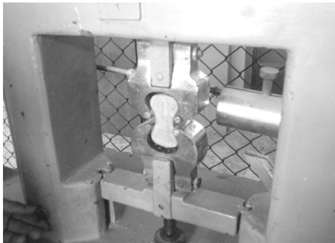
Figura 25. Fotografía del ensayo de briquetas a tensión.
