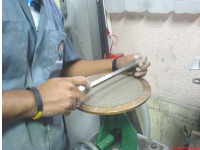
Figura 19. Fotografía de la medición de un flow
