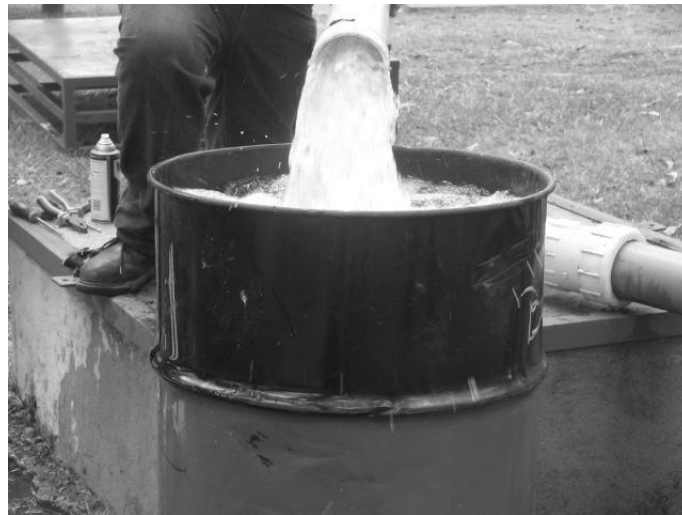
Figura 14. Aforo volumétrico a pozo 1, División de Servicios Generales
