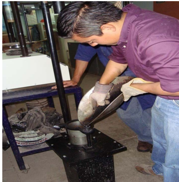
Figura 24. Colocación de mezcla asfáltica en moldes precalentados
