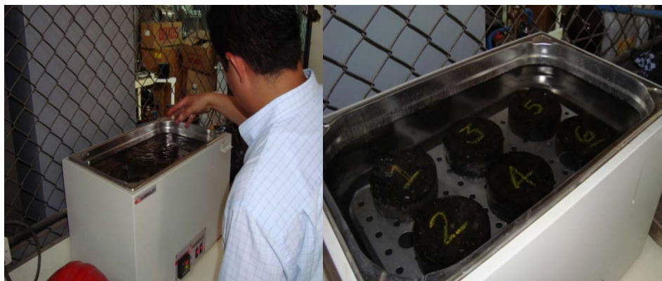
Figura 29. Colocación de pastillas en baño maría antes de ser ensayadas
