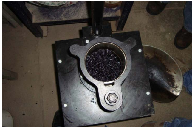
Figura 25. Mezcla asfáltica colocada en molde, antes de ser compactada
