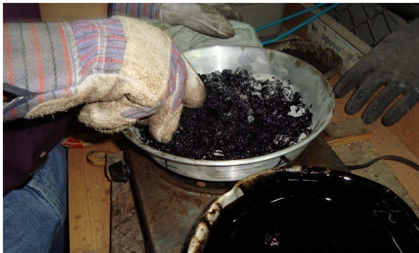
Figura 23. Mezclado de agregados y AC.
