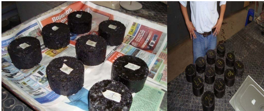
Figura 28. Curado de pastillas antes de ser ensayadas en la máquina Marshall
