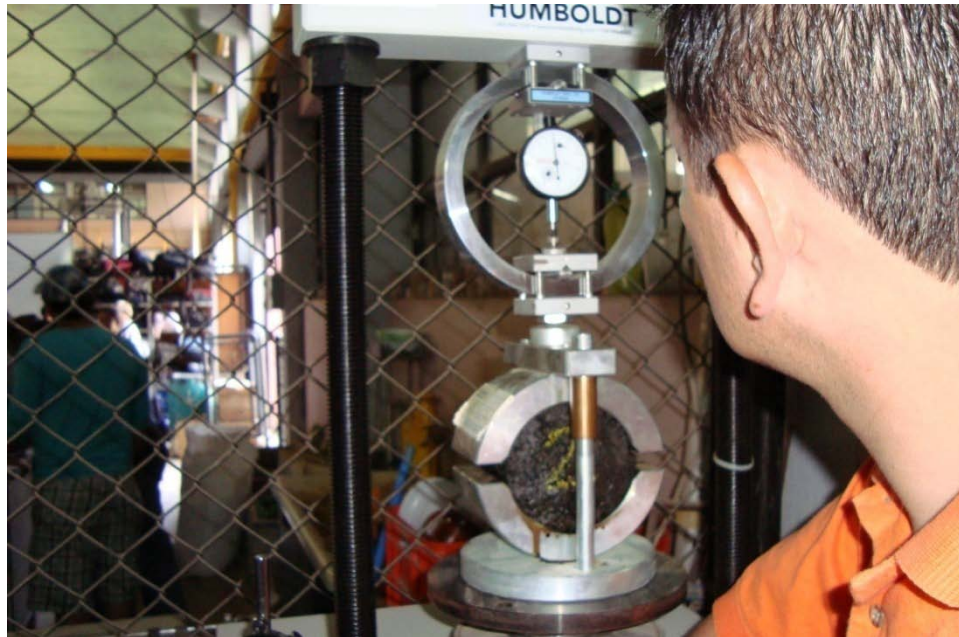
Figura 30. Ensayo de probetas en máquina Marshall.
