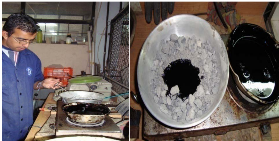
Figura 22. Calentamiento de agregados de AC
