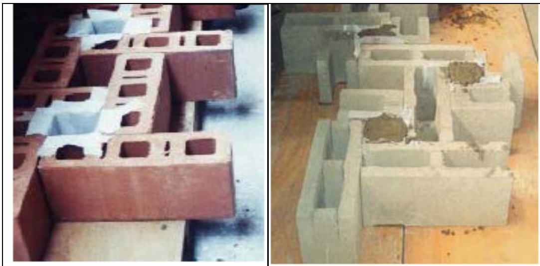
Figura 6 Elaboración de probetas resistencia a compresión grout en obra
