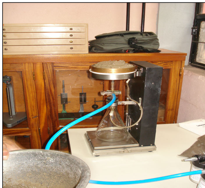
Figura 10 Equipo de ensayo retención de agua
