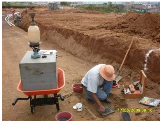
Figura 25. Prueba de densidad de campo en bases y subrasantes
