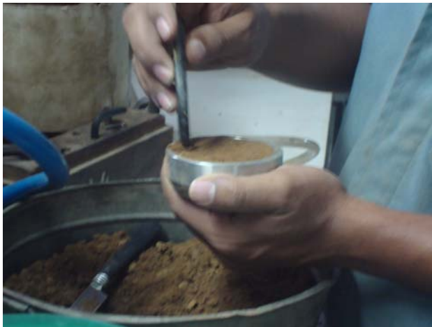
Tallado de muestra para ensayo corte directo
