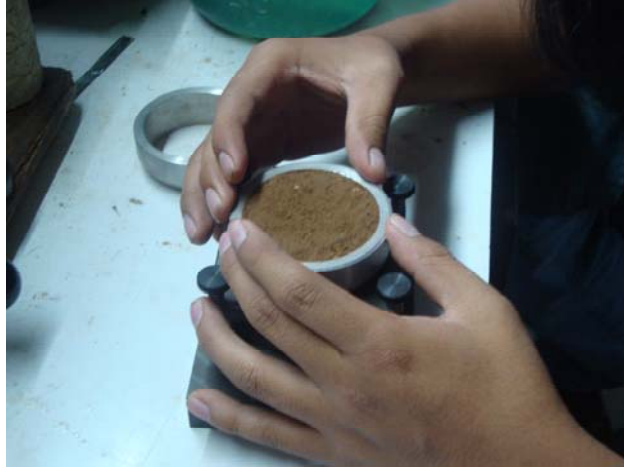
Colocación de anillo en base para ensayo de corte directo
