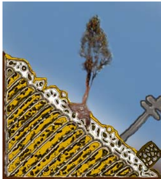
Figura 4. Reptación de suelo
