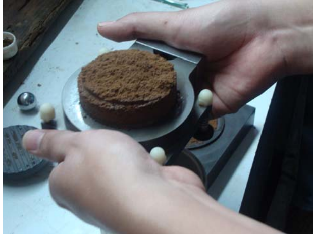
Muestra ensayada por medio de corte directo
