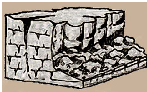
Figura 3. Derrumbe y caída de bloques
