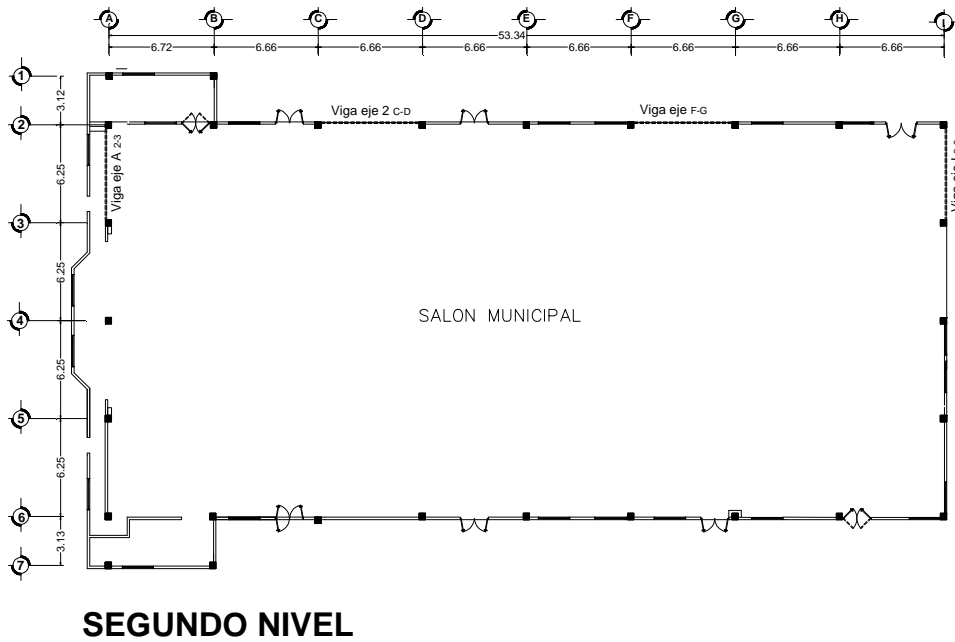
Figura 10. Vista en planta de segundo nivel con vigas a analizar
