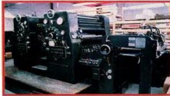
Heidelberg RZO de dos colores. Imprime dos colores por Ingreso de material.
