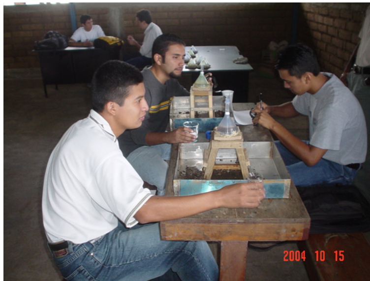
Figura 26. Ensayo de permeabilidad.
