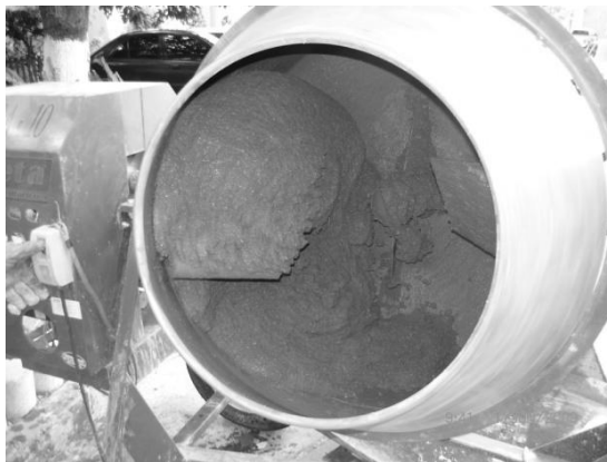
Figura 17. Concretera del Centro de investigaciones de Ingeniería en donde fue realizada la mezcla de concreto que contenía como agregado fino la escoria de mata de níquel.
