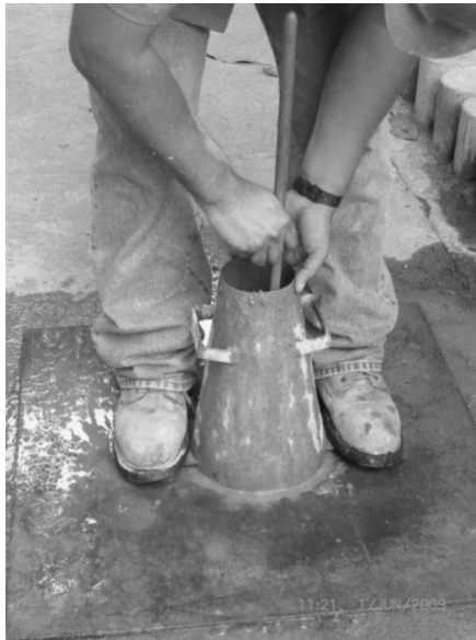
Figura 10. Cono de Abrams utilizado en la prueba de asentamiento, colocación y forma de llenado.
