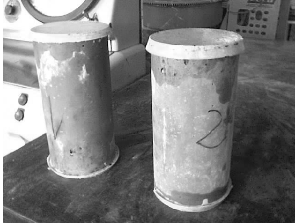
Figura 26. Cilindros de concreto coronados con solución de azufre para su nivelación.
