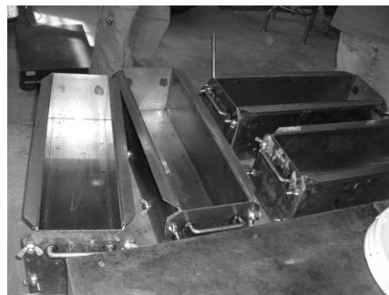
Figura 21. Moldes para vigas según norma ASTM C 192.
