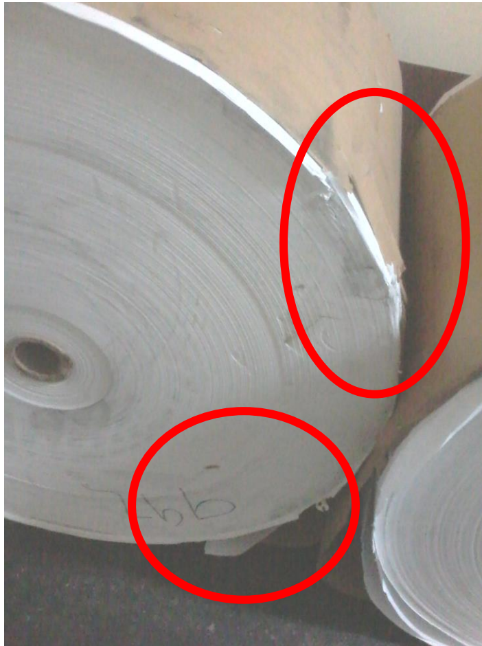
Figura 7. Bobina de papel dañada por los brazos del montacargas
