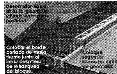
Instalación y fijación de la geomalla.
