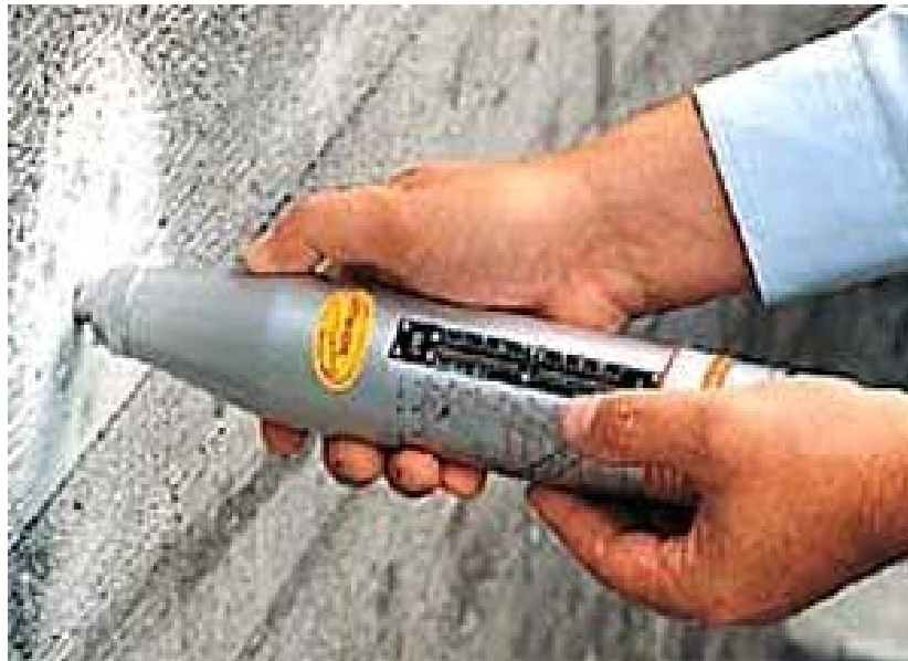
Figura 3 END Martillo Schmidt resistencia a compresión
