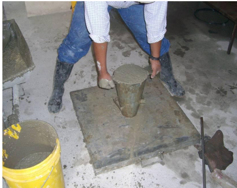
Figura 4 Ensayo de trabajabilidad concreto autocompactante
