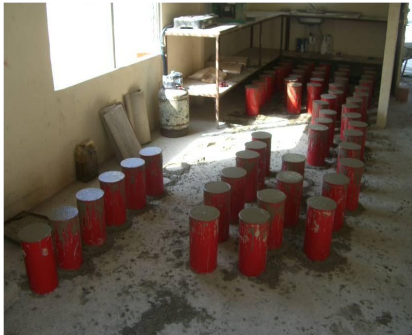
Figura 6 Probetas normalizadas para el ensayo a compresión concreto (ASTM C-39)
