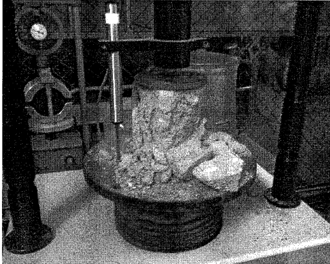
Figura 29. Falla total por la aplicación de carga a compresión
