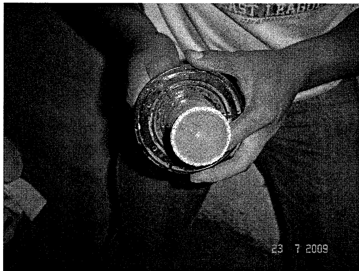
Figura 57. Testigo extraído para determinar porcentaje de humedad y densidad de la mezcla.
