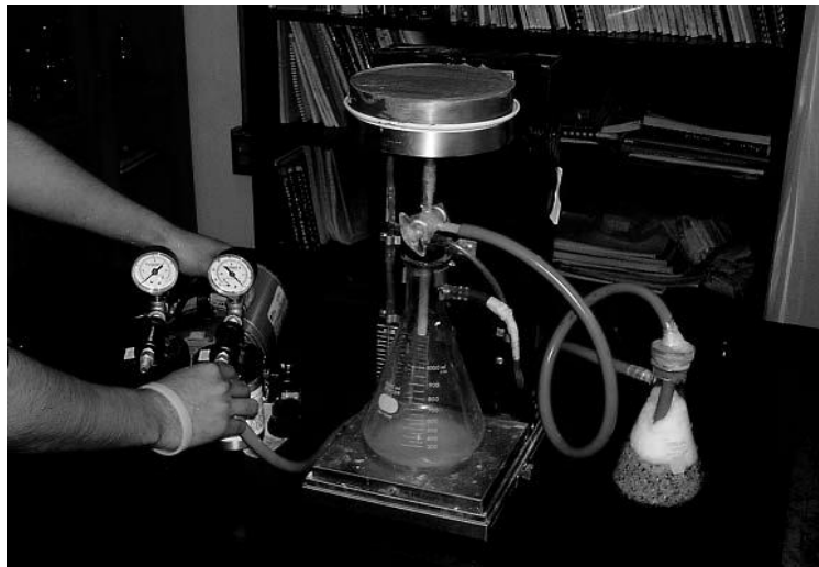
Figura 10. Ensayo de retención de agua
