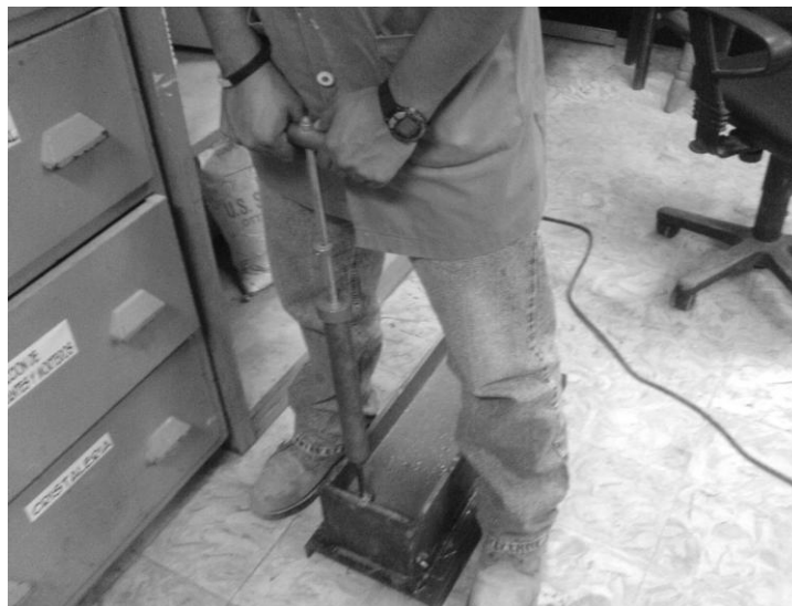
Figura 12. Ensayo de velocidad de endurecimiento por el método de resistencia a la penetración
