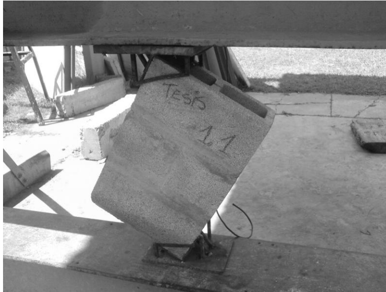
Figura 18. Ensayo de corte efectuado a los prismas de mampostería
