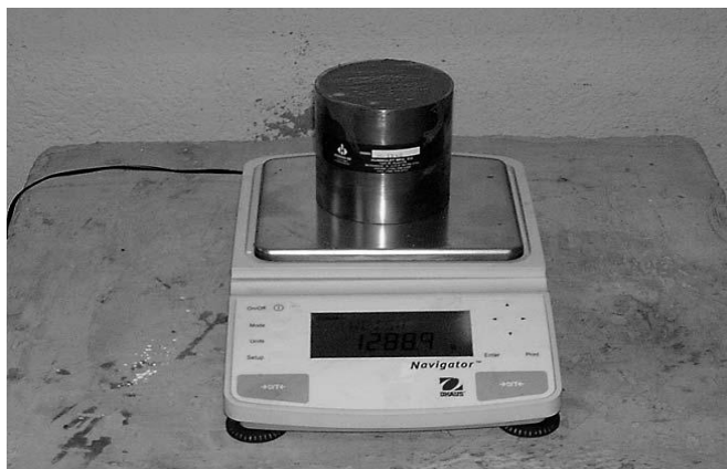
Figura 11. Ensayo de masa unitaria
