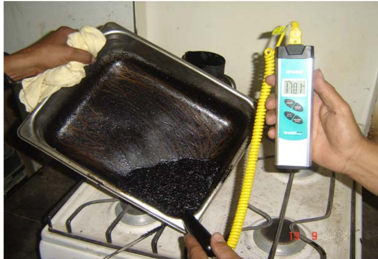
Figura 27. Mezcla de asfalto con agregados a temperatura especificada
