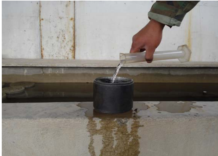
Figura 11. Ensayo de permeabilidad sobre la briqueta
