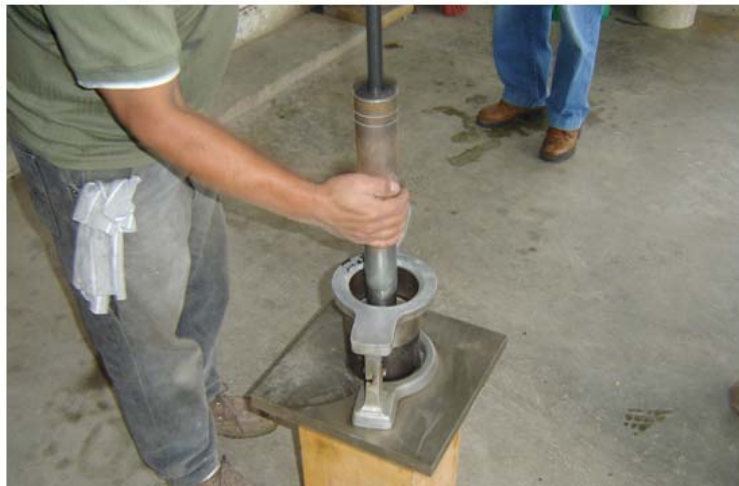
Figura 13. Compactación de briqueta
