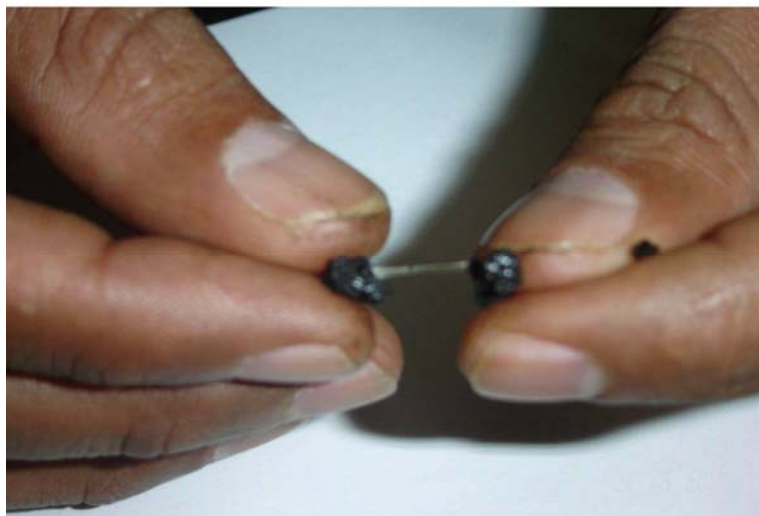
Figura 3. Elasticidad del asfalto modificado
