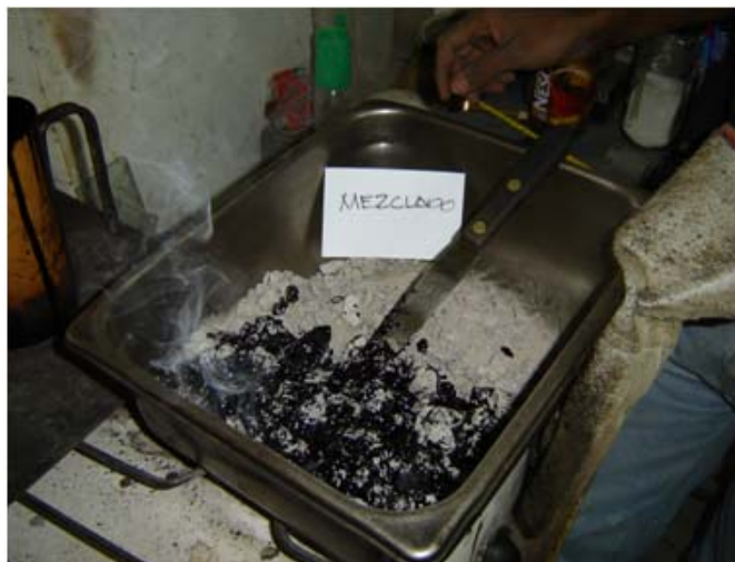
Figura 15. Mezcla de Asfalto con Agregados
