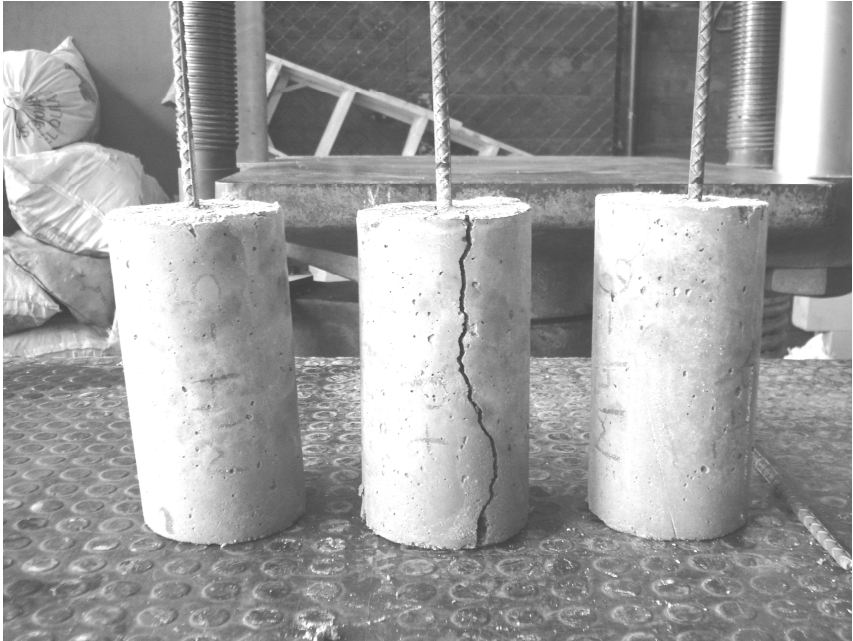
Figura 18. Tipo de falla ensayo de adherencia concreto-varilla.
