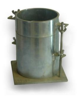
CBR (California Bearing Ratio: Ensayo de Relación de Soporte de California)
