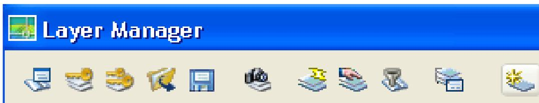
Seguido se procede a diseñar el alineamiento horizontal con el comando Line, es importante mencionar que en estos momentos se deben apagar algunos layers, con los comandos de apagar y encender layers de el programa para trabajar con mayor facilidad y visualizar mejor la pantalla.
