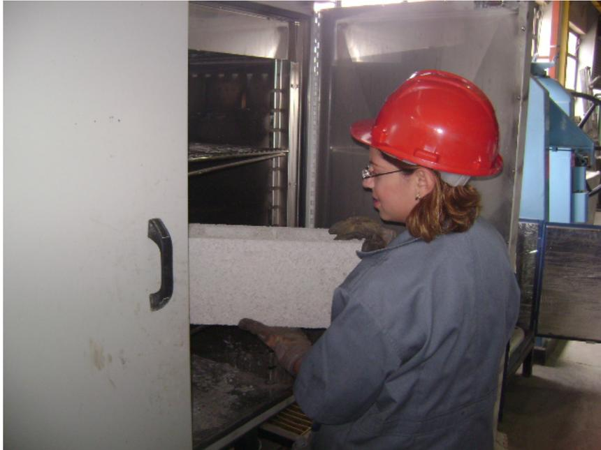
**Figura 14. Se obtienen los especímenes totalmente secos y se prosigue con su enfriamiento.**
