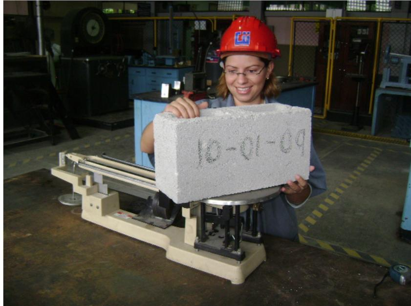
**Figura 12. Colocación de los distintos pesos para determinar su peso real en estado seco y húmedo sumergido en las pilas con agua.**
