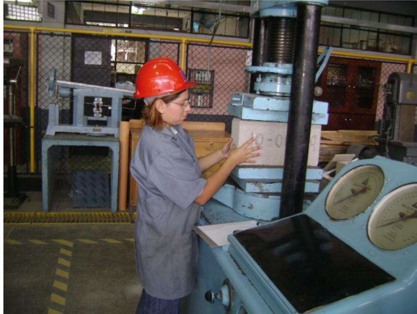
**Figura 16. Se procede a aplicar la carga a los distintos especímenes, observando su falla en laboratorio.**
