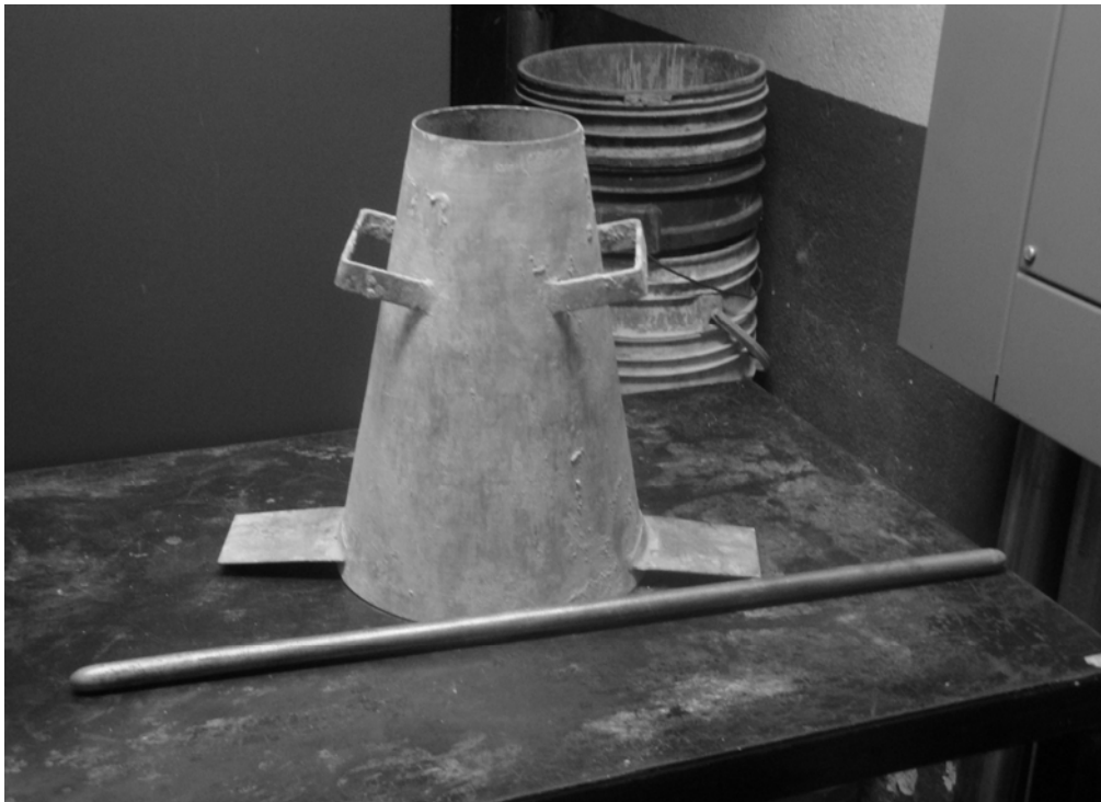
Figura 17. Equipo para ensayo de asentamiento
