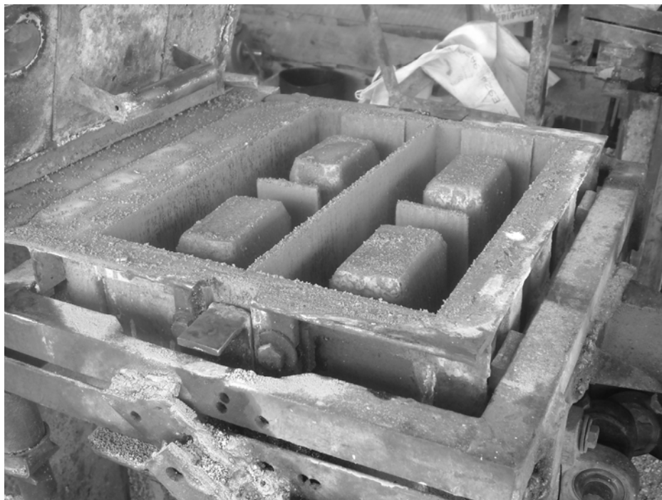
Figura 28. Moldes para block de 15*20*40 cms
