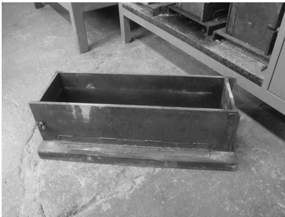
Figura 26. Moldes para vigas
