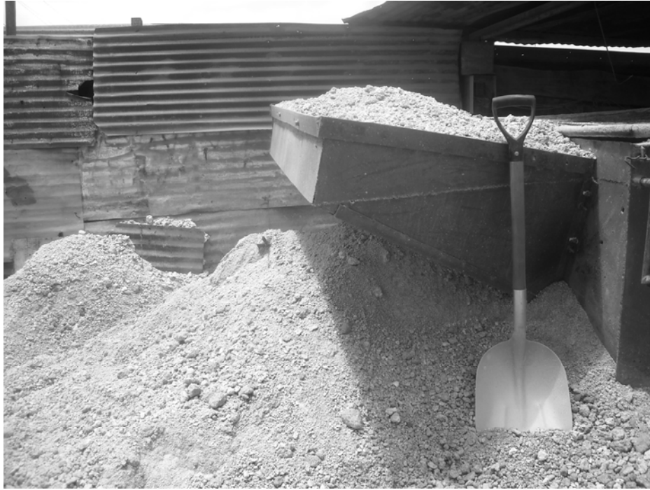
Figura 28. Moldes para block de 15*20*40 cms
