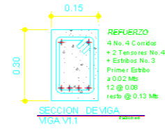
DETALLE DE VIGA V1.1
