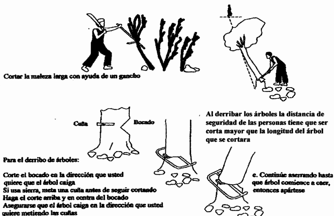
Figura 4. Limpieza de terreno
