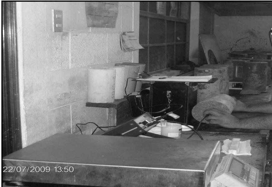
. Fuente: Fotografía tomada durante realización de ensayo de velocidad de pulso en el concreto en Centro de Tecnología del Concreto de Cementos Progreso. CETEC.
