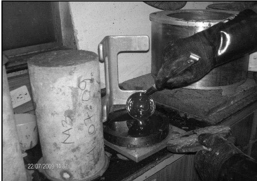
. Fuente: Fotografía tomada después de ensayo de velocidad de pulso en el concreto en Centro de Tecnología del Concreto de Cementos Progreso. CETEC
