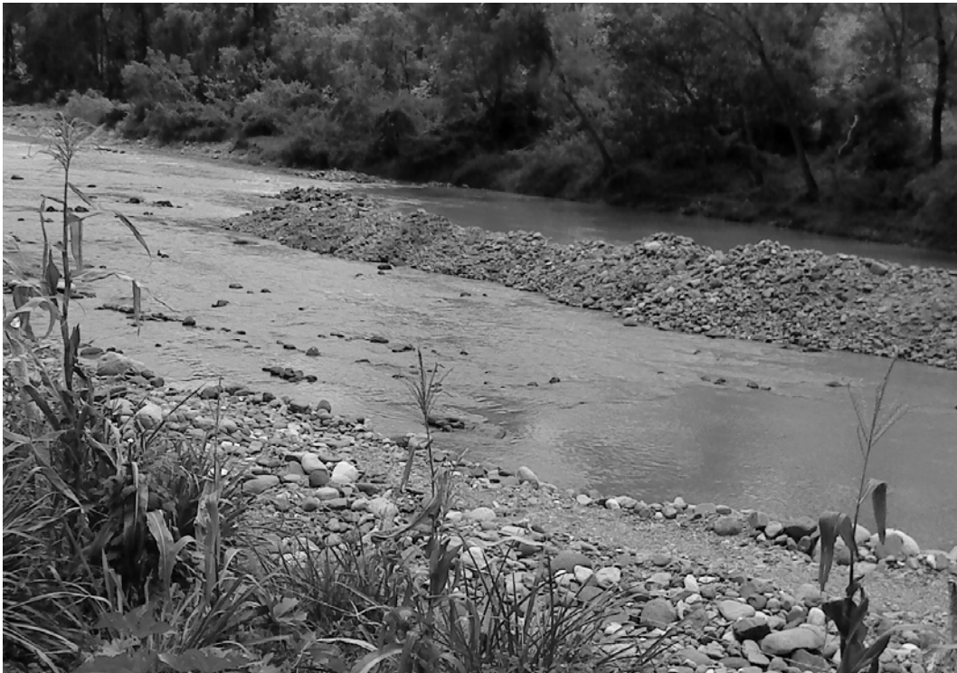
Figura 46. Trinchera cavada en lecho de río para extraer material, banco dos AGREGUA, TYRSA “Los Esclavos”.
