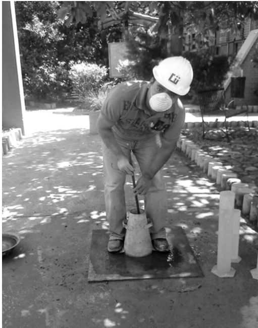
Apisonando el material en Cono.
