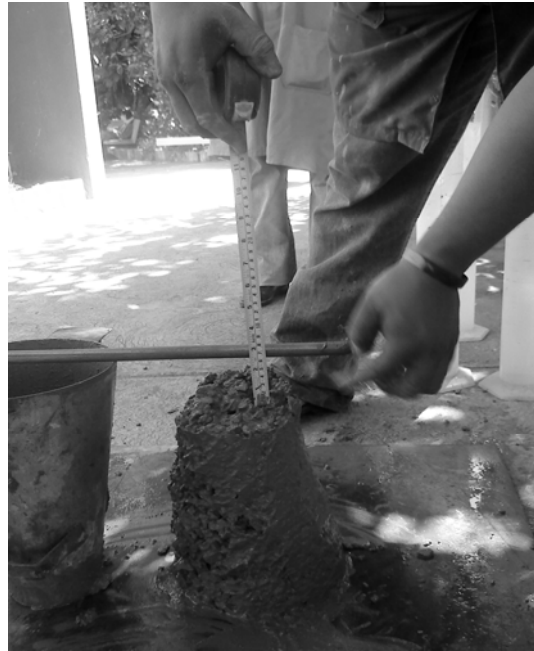
Prueba del slump, trabajabilidad
